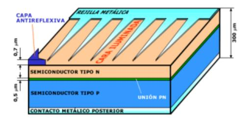
Nota. Célula solar fotovoltaica. (Monsolar, 2010). Componentes de una celda fotovoltaica.
