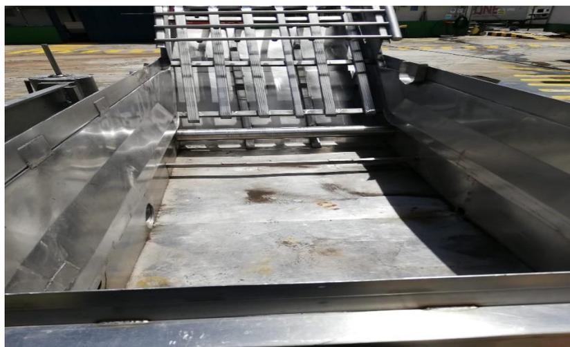
**Figura 13.** Modificación estructural de la cuba de lavado.
