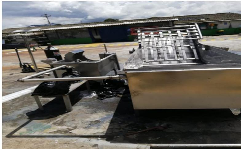
**Figura 14.** Implementación del sistema del filtro en la cuba de lavado.
