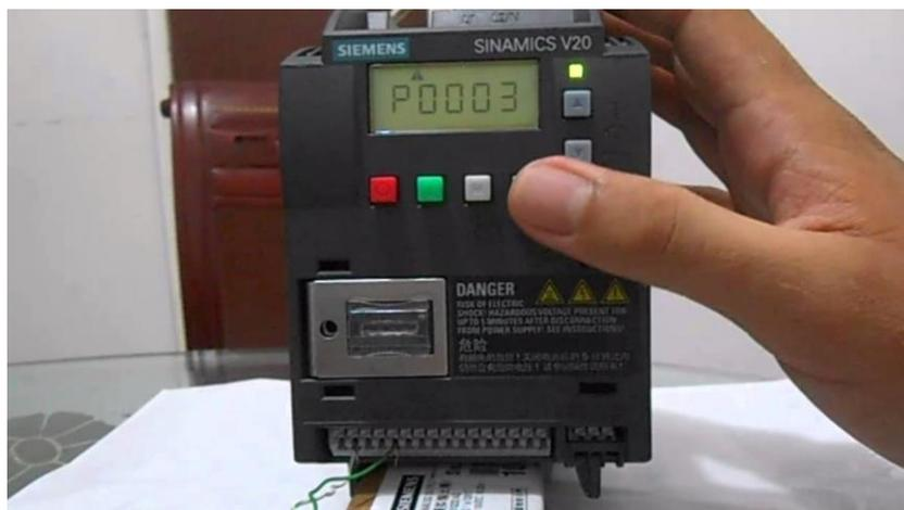
**Figura 5.** Variador sinamics V20 (2020).
