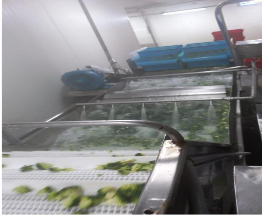
**Figura 31.** Cuba de lavado en funcionamiento.
