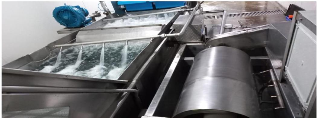
**Figura 24.** Pruebas de funcionamiento de la cuba en vacío.
