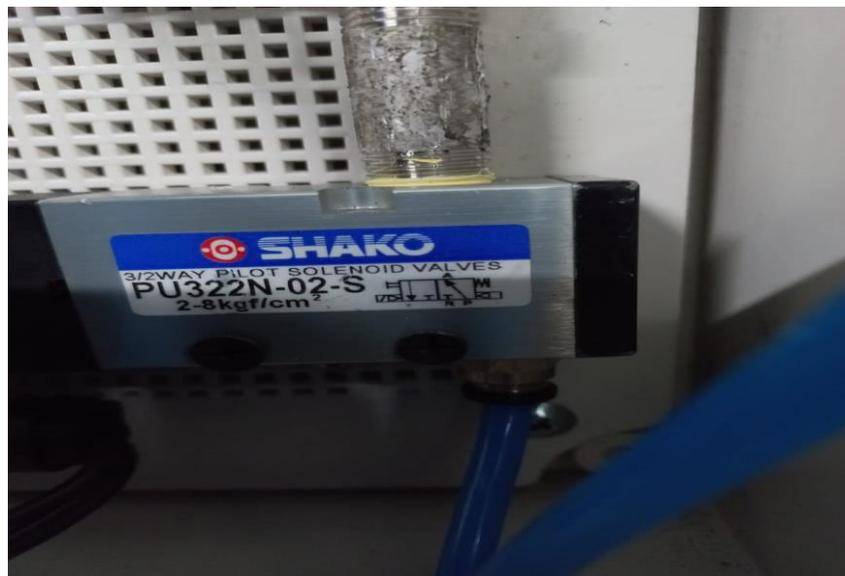
**Figura 20.** Instalación de válvulas neumática.
