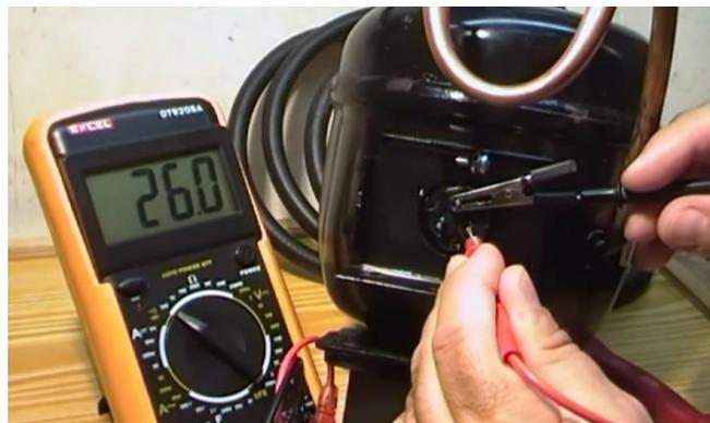
**Imagen No. 36** Medición de la bobina C y M
