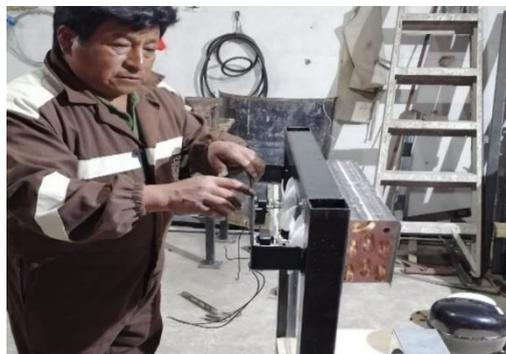
**Imagen No. 30** Armadura de ventiladores en el serpentín y evaporador
