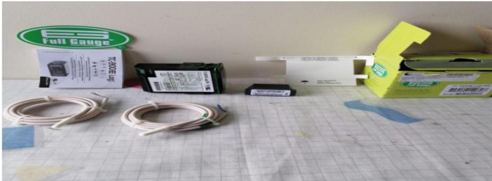
**Imagen No. 9** Sondas de temperaturas
