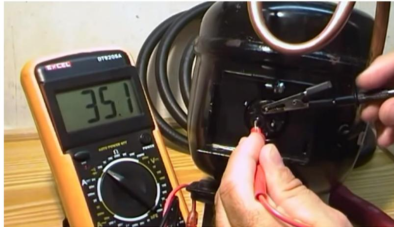
**Imagen No. 37** Medición de la bobina C y S
