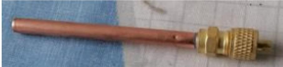
**Imagen No. 14** Válvula de succión y carga
