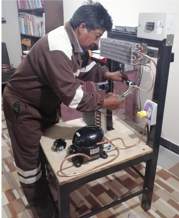
**Imagen No. 52** Ajustes de las tuberías
