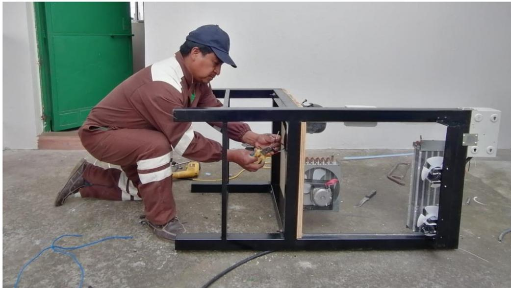
**Imagen No. 50** Instalación del compresor en la base
