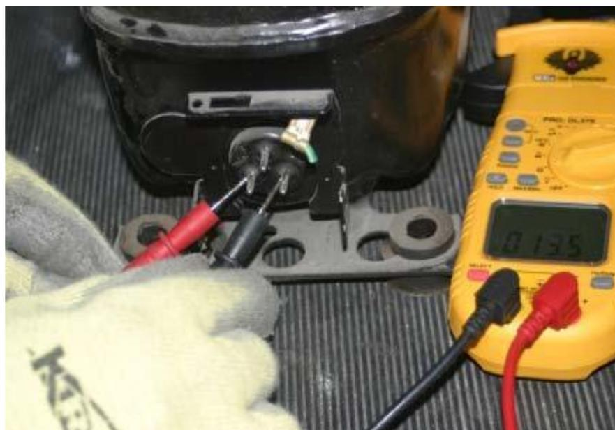
**Imagen No. 39** Medición de voltaje
