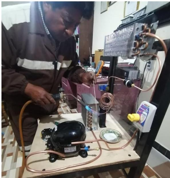
**Imagen No. 53** Soldadura de las tuberías
