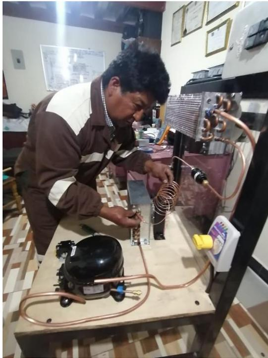
**Imagen No. 54** Colocación de implementos de los módulos de refrigeración
