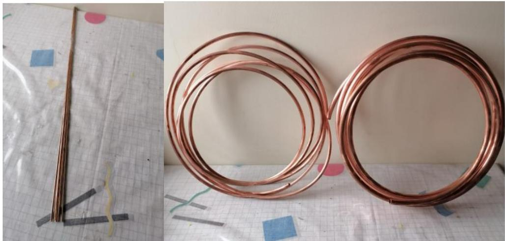
**Imagen No. 15** Cañerías o tuberías de cobre
