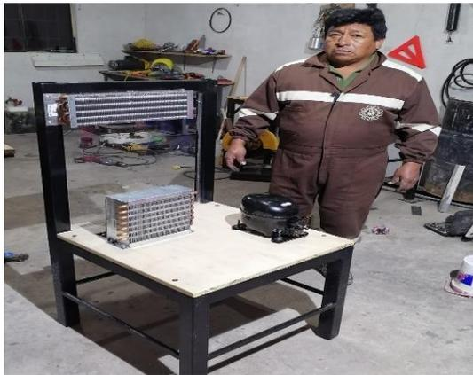
**Imagen No. 29** Proceso de inserción de los elementos dentro del módulo de hierro
