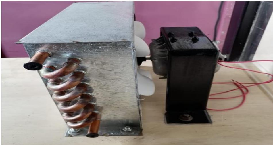
**Imagen No. 12** Serpentin y su ventilador para el proceso de enfriamiento
