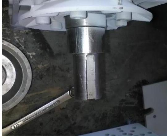
Imagen No. 22 Eje de velocidad lenta del reductor
