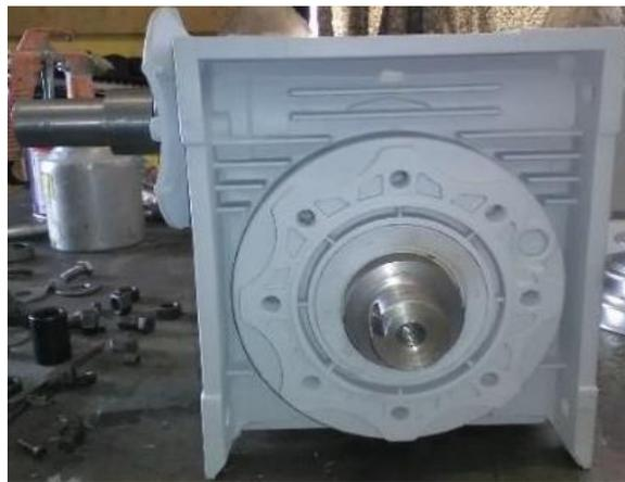
Imagen No. 19 Reductor de velocidad y proceso de perforado de la base de sujeción
