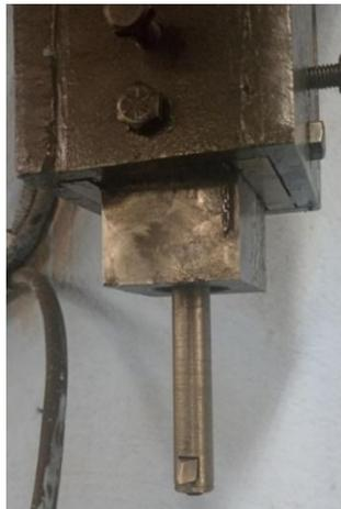
Imagen No. 44 Colocación del portaherramientas y cuchilla
