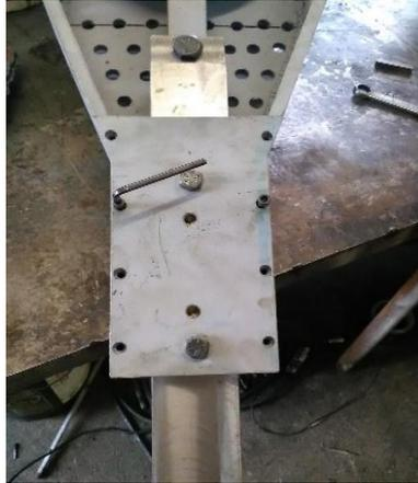
Imagen No. 39 Ensamble de la tapa superior de corredera
