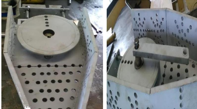
Imagen No. 37 Sistema de transmisión biela – manivela
