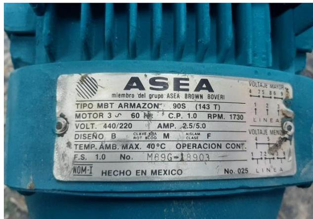
Imagen No. 18 Placa de identificación de motor trifásico de 1/2(HP)
