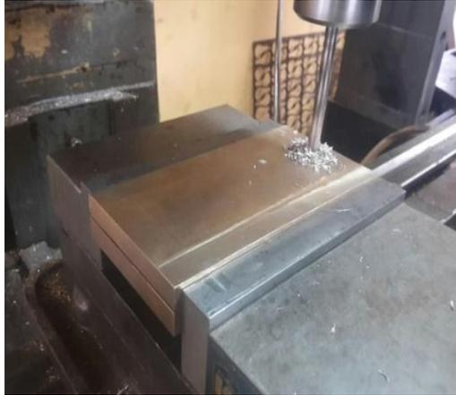
Imagen No. 29 Proceso de perfora de placas de bronce fosfórico
