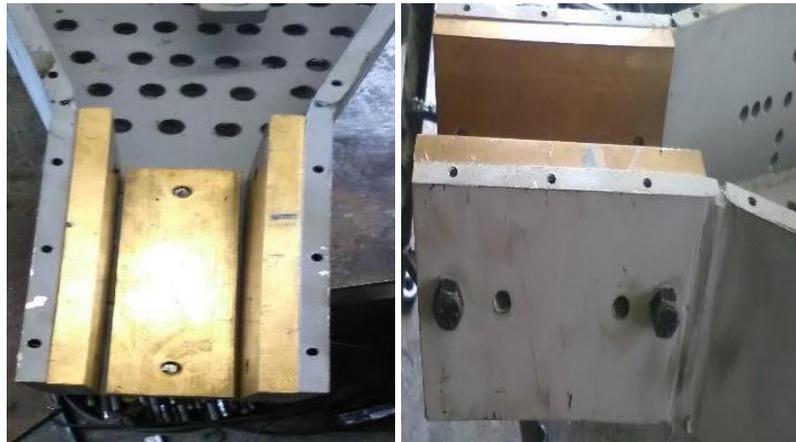
Imagen No. 34 Acoplamiento de placas de bronce fosfórico
