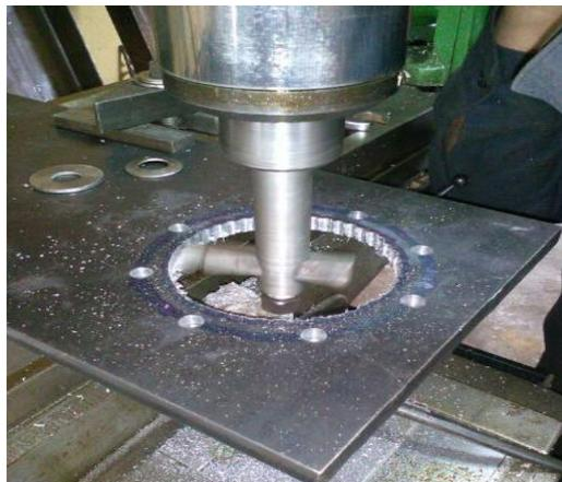
Imagen No. 20 Proceso de fresado
