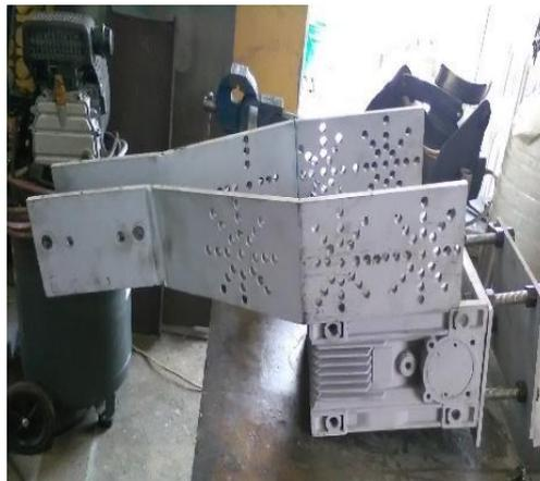
Imagen No. 36 Montaje del esqueleto del cabezal mortajador
