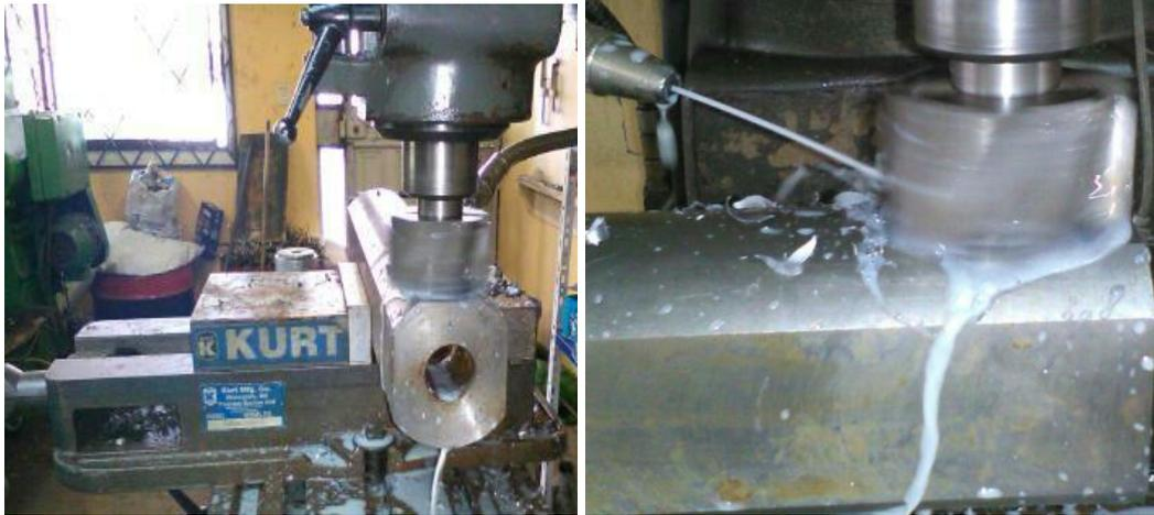
Imagen No. 27 Mecanizado del eje
