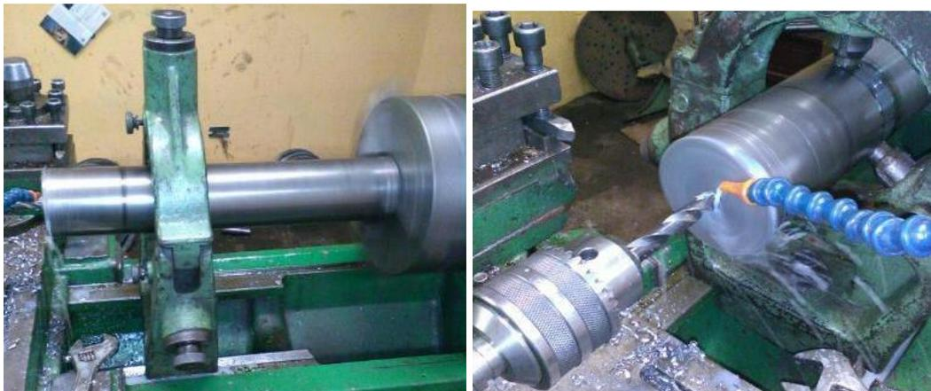
Imagen No. 26 Perforación del eje
