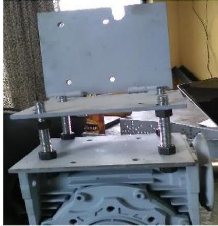
Imagen No. 33 Montaje de la base del motor
