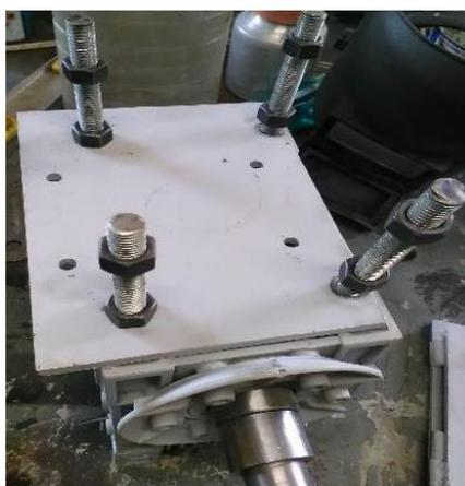
Imagen No. 32 Montaje de la base del motorreductor
