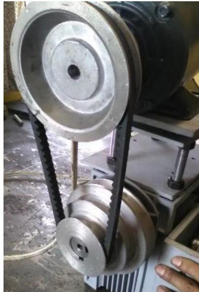
Imagen No. 15 Sistema de transmisión de movimiento polea-correa (opción 1)
