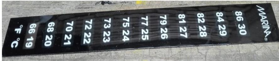
Figura 22. Termómetro medidor de temperatura de agua.
