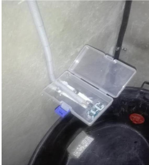
*Figura 38.* Implementación del sensor ultrasónico HC-SR04 en el sistema.
