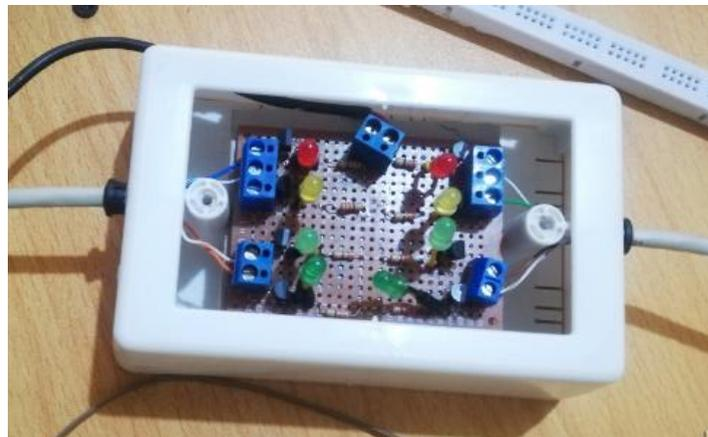
*Figura 33.* Implementación de la placa electrónica en cajetín.
