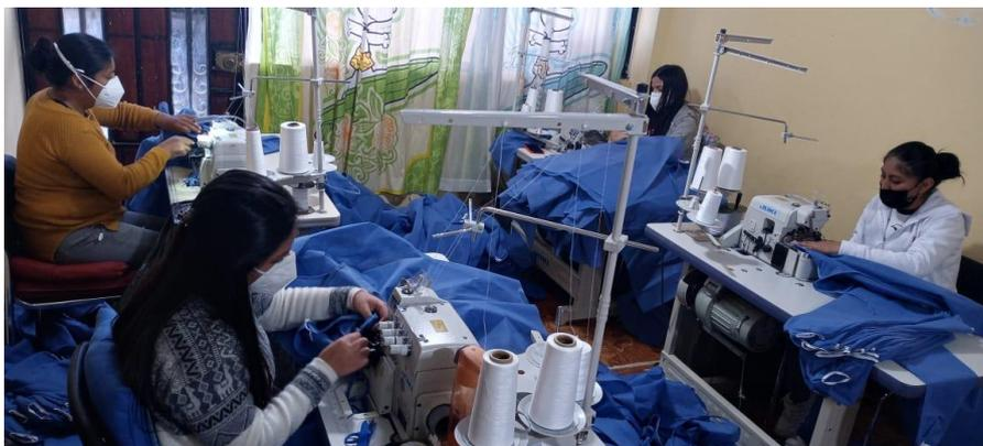
**Imagen No. 39** Proceso de la elaboración de batas descartables
