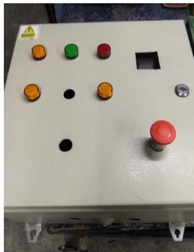
**Imagen 37.** Montaje de pulsadores y luces piloto
