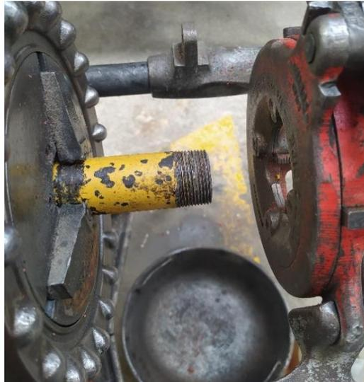
**Imagen 39.** Roscado de tuberías y neplos
