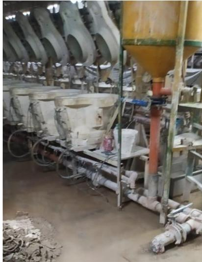
**Imagen 74.** Fuga de agua de moldes
