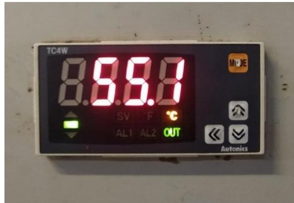
**Imagen 21.** Controlador de temperatura TC4W
