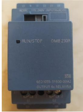
**Imagen 17.** Módulo expansor DM8 230R.
