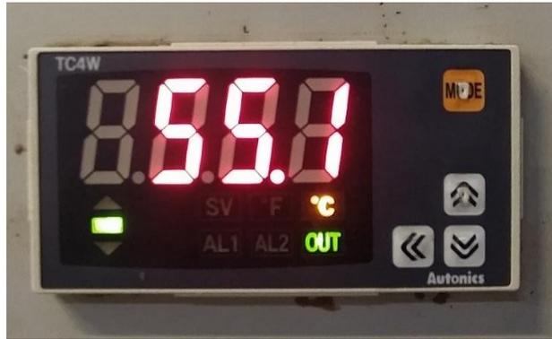
**Imagen 12.** Controlador de temperatura TC4W
