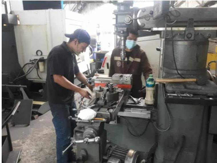
**Imagen No. 25** Perforación de placa de 6mm de espesor
