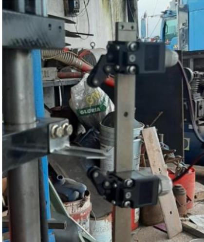
**Imagen No. 48** Instalación de fines de carrera
