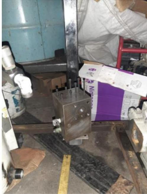
**Imagen No. 35** Instalación del bloque porta válvulas
