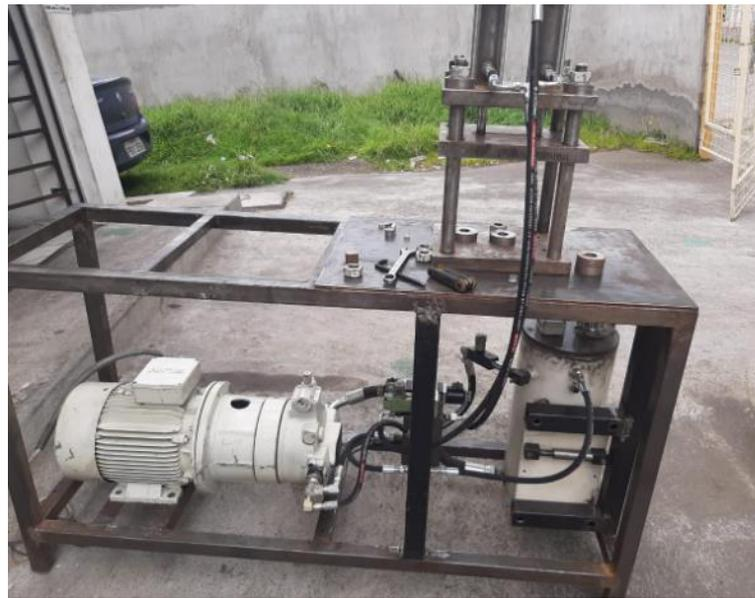
**Imagen No. 39** Instalación de mangueras oleohidráulicas
