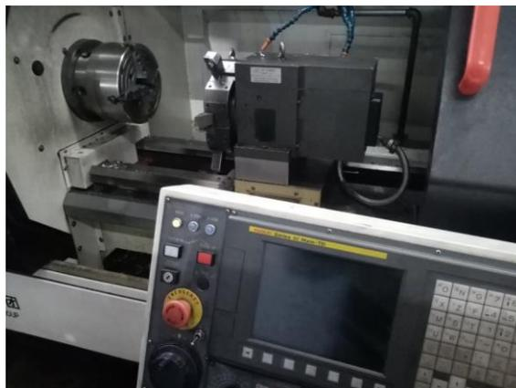
**Imagen No. 21** Torno CNC para maquinado de columnas
