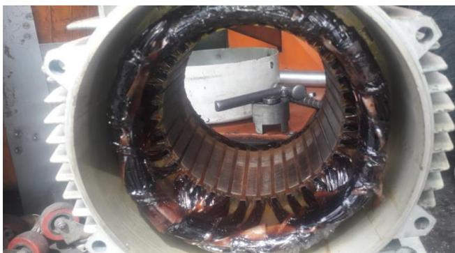
**Imagen No. 53** Estator quemado
