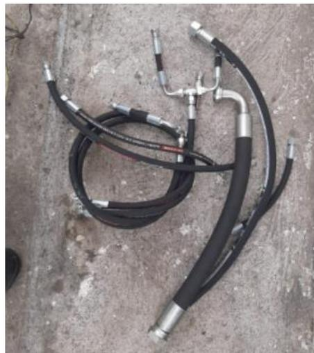
**Imagen No. 38** Mangueras oleohidráulicas
