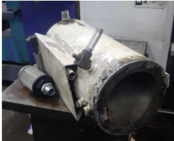
**Imagen No. 29** Soldadura de tubería en el tanque de aceite
