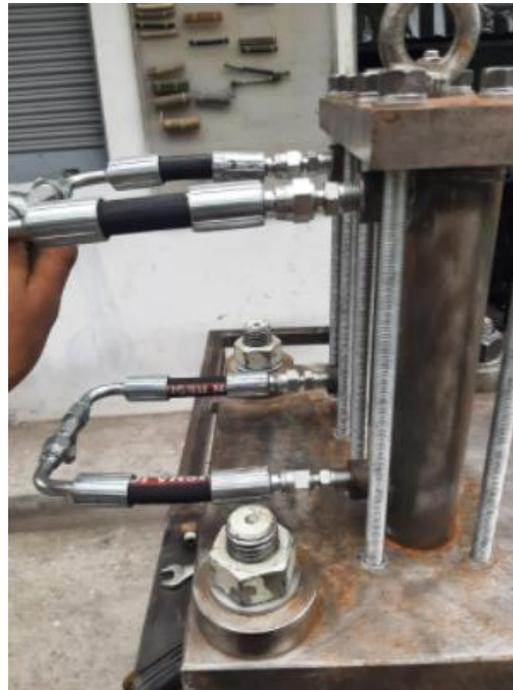
**Imagen No. 57** Conexiones oleohidráulicas
