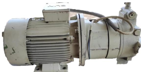
**Imagen No. 6** Motor y bomba hidráulica
