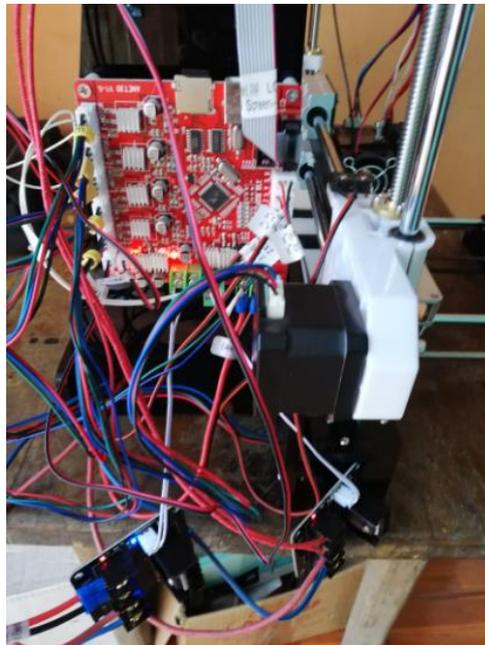
*Figura 67.* Conexiones Tarjeta de Control.
