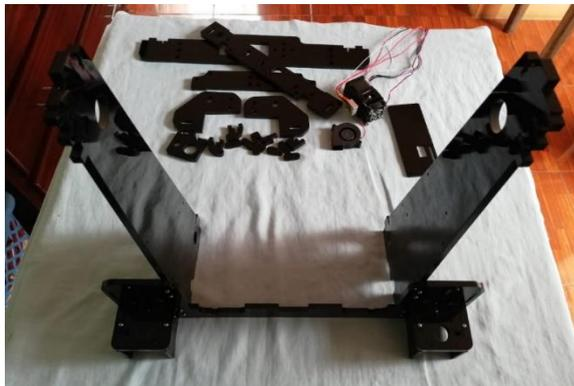
*Figura 50.* Estructura de acrílico.
