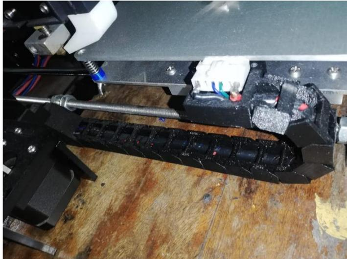
Figura 88. Soporte cableado eje Y.
