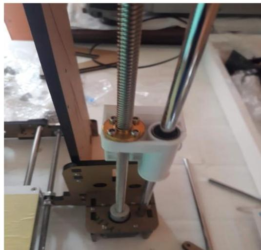
*Figura 56.* Colocación de las varillas y husillo.
