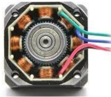
*Figura 14.* Motor paso a paso.
