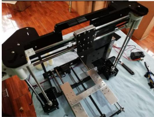
*Figura 32.* Estructura del eje Z.
