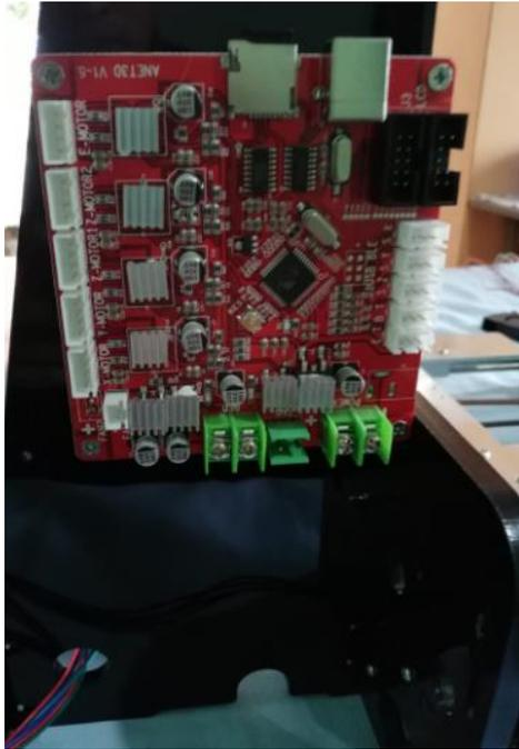
*Figura 60.* Montaje de la tarjeta de control.
