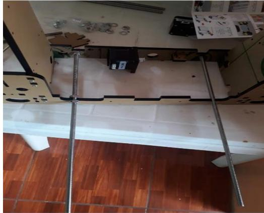
*Figura 51.* Colocación del Motor Paso a Paso en el Soporte.
