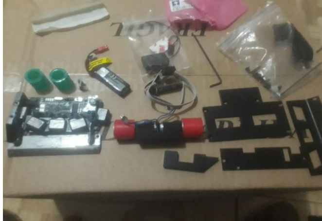
Figura 15: Piezas del robot cortadas a laser Fuente: Elaboración propia (2020)
