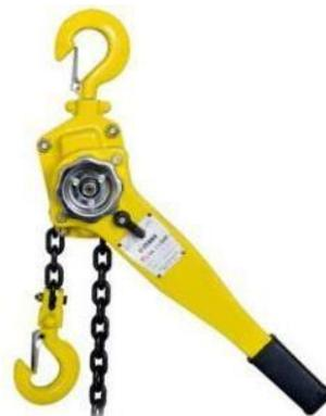
Figura 3. Tecele manual con palanca
