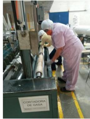
*Figura 50. Cambio de eje para rollos.*
