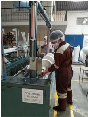
*Figura 51. Acople de rollos en la máquina*
