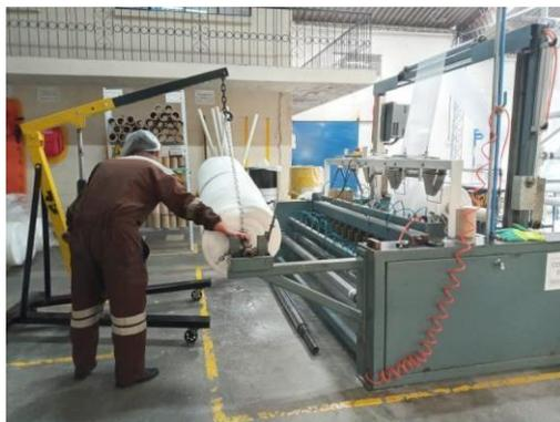
*Figura 59. Acople de rollo a máquina*
